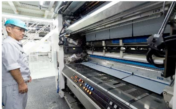
輪転機へのプレート装着作業。刷版自動着脱装置により効率的に行なえる。
