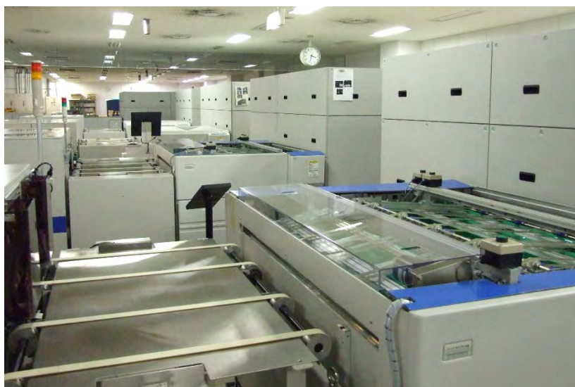
手前 2 ラインが無処理専用。自現機上にコンベアを設置し、プレートを通して
