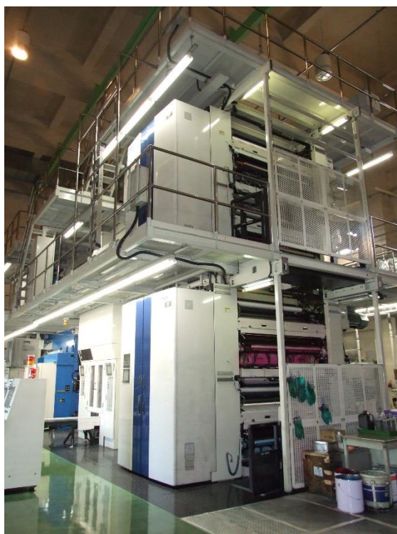
最大 24 ページ、カラー12 面の印刷が可能なタワー型輪転機を備える
