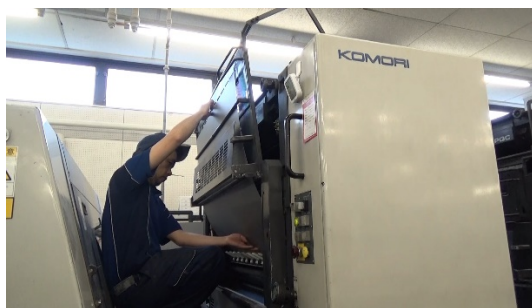
プレート交換の様子。現場では「キズが付きにくく、扱いやすい」と好評
