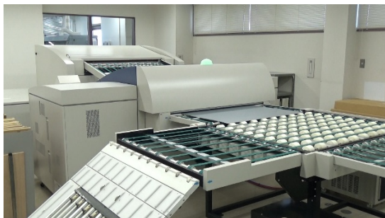
CTPライン。水あり無処理プレートと水なしプレートがコンベア上で振り分けられる
